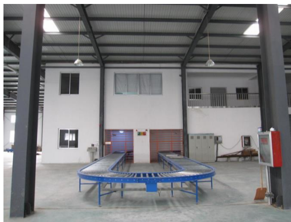
图10-1 迷道进出口及传送链设计的效果图
